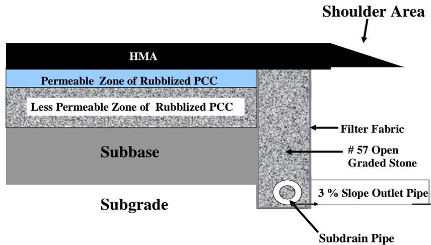
**Figure 6.1, Typical Edge Drain System**
