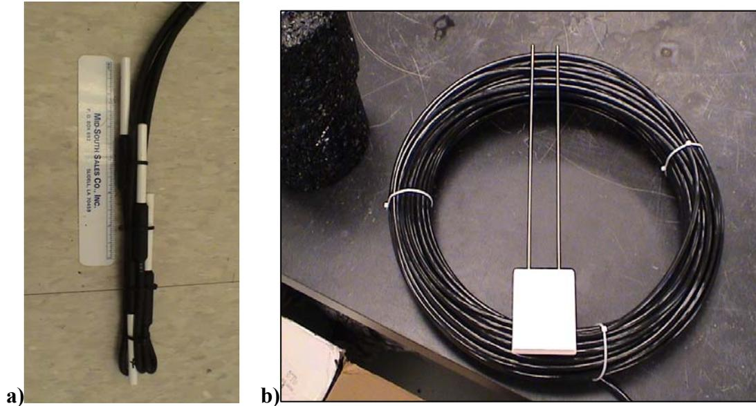
**Figure 3.4 In Situ Instruments a) Thermistor Bundle b) TDR.**
